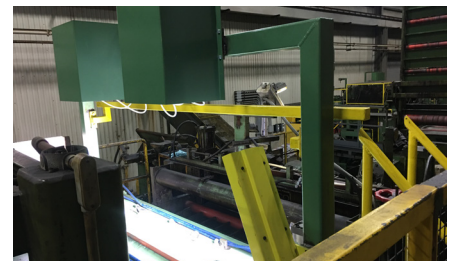
安装在Samuel Nelson Steel (加拿大安大略省斯托尼克里克)的SmartView®表面检测系统。
